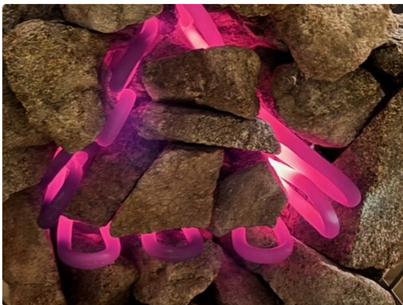
Vastukset ovat vääntyneet pahoin ja vastaavat toisiinsa.
